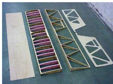
La structure du plan arrière horizontal assemblé
