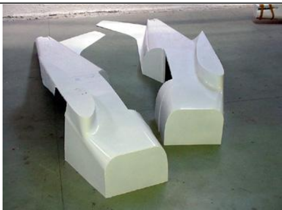
Demie coque carbone pour habillage du fuselage
