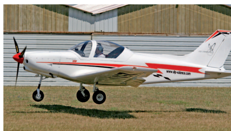
À l'atterrissage, la grande gouverne de lacet empêche tout moment de flou lors de la phase de transition.
